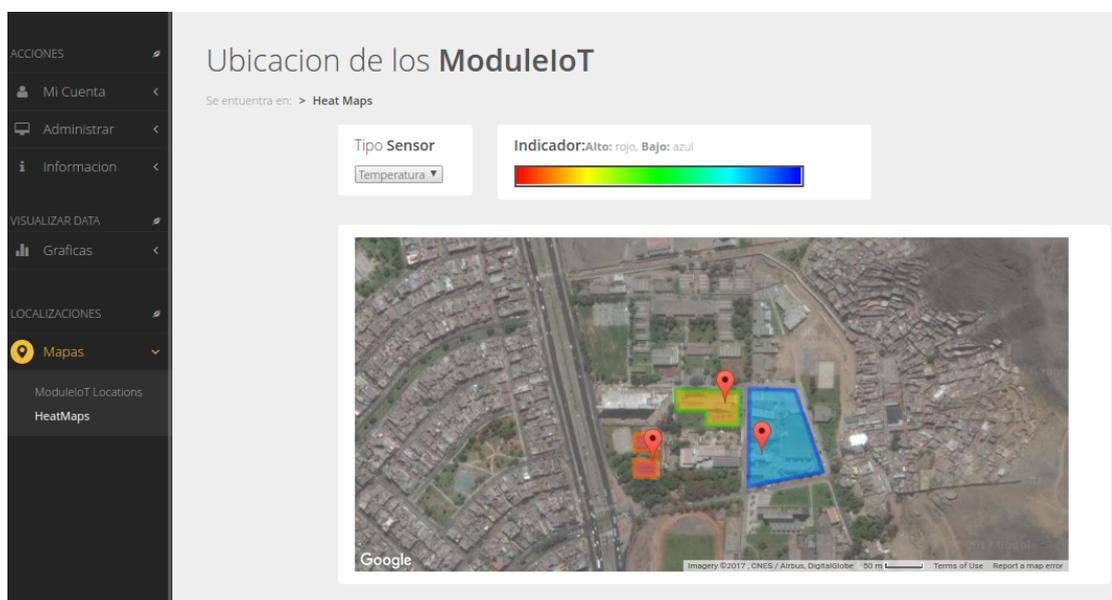
FIGURA 5.15: Mapas de calor de los valores censados representados en las áreas de los módulos. Fuente: Elaboración propia.
